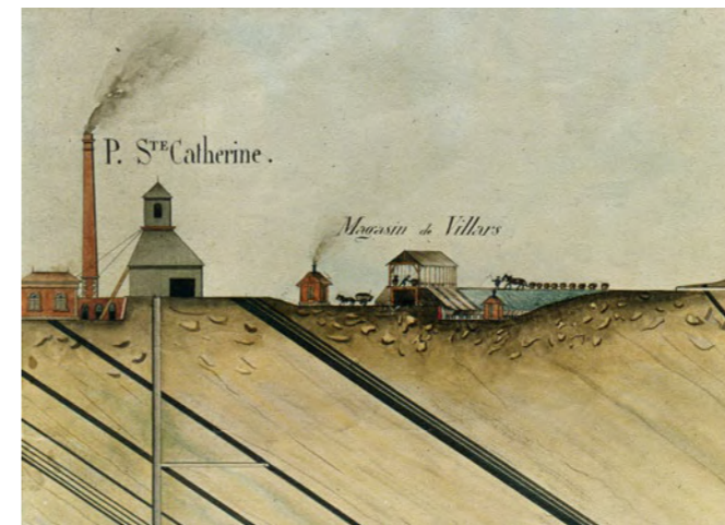
Coupe du terrain houiller entre les puits Ste Catherine, de Beaunier, de Gallois, de Montmey et de Palluat Exposition universelle de 1867 Société Anonyme des Mines de la Loire, 1867, inv. 2008.0.823 © Ville de Saint-Étienne
