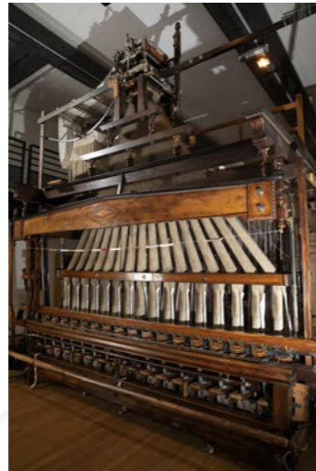
Métier à tisser les rubans avec mécanique Jacquard Saint-Étienne, musée d'Art et d'Industrie, inv. 81.13.2 © Ville de Saint-Étienne / Hubert Genouilhac - PhotUp Design
